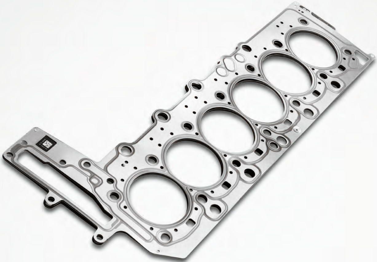
4,5-lagige Metaloflex™-Zylinderkopfdichtung mit partieller Beschichtung und Hinterland-Abstützung.
